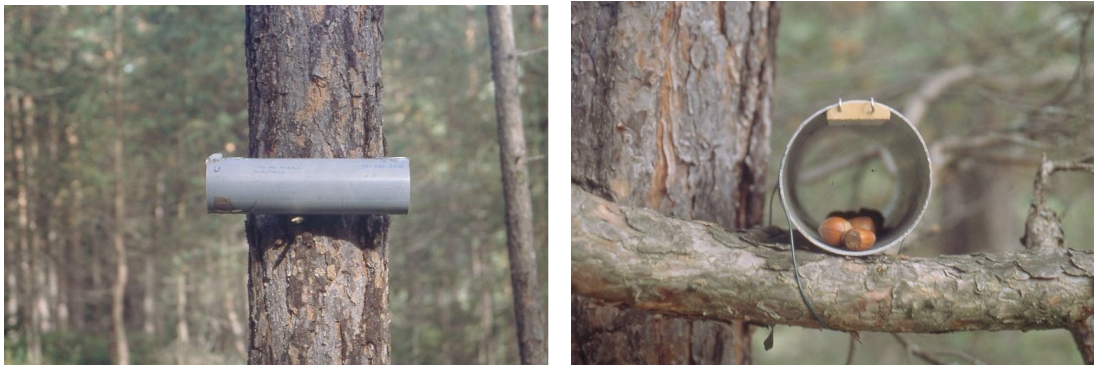
Figura 4.1 - Hair-tube "attivato" con nocchie e semi di girasole e dotato di nastro biadesivo ai due ingressi.
